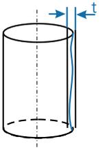
**Geradheit** Die Toleranzzone wird begrenzt durch zwei parallele Geraden vom Abstand  $t$ . Jede Mantellinie des tolerierten Zylinders muss zwischen diesen beiden parallelen Geraden liegen.
