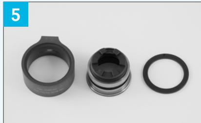
5 Alle Teile mit Industriereiniger reinigen.
