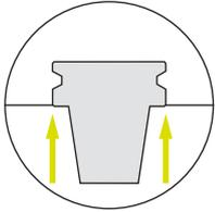
Höhere Steifigkeit durch Kegelanlage (AT1) und Plananlage.
