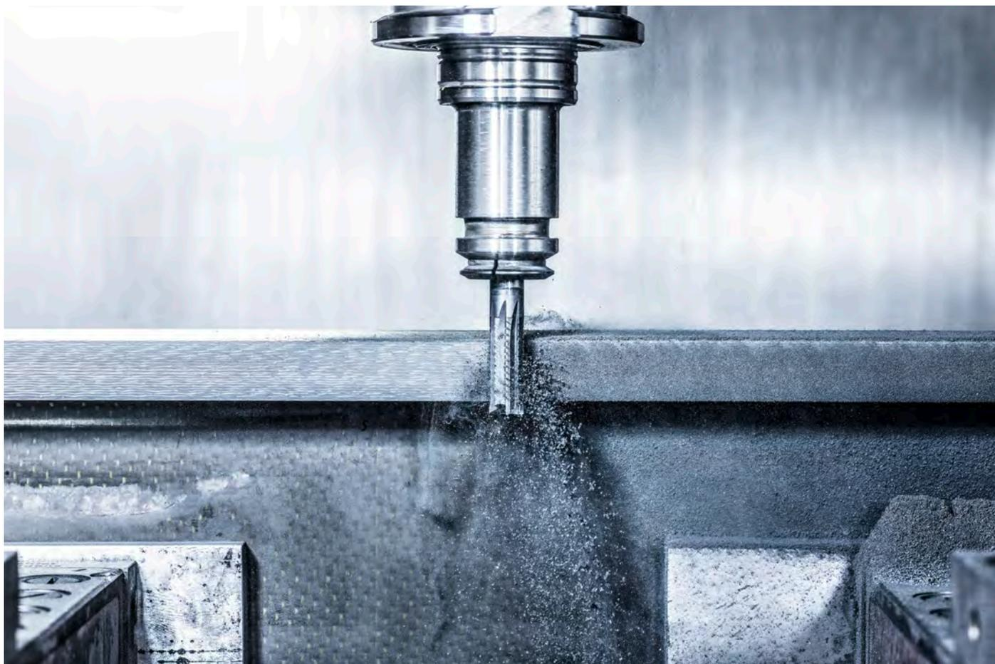
Strategie und Einsatzdaten können auf das Maschinenumfeld angepasst werden: optimale Nutzung des bestehenden Maschinenparks und optimale Bearbeitung auch labiler Bauteile. Weiche, abgerundete Werkzeugwege und konstante Bearbeitungstemperaturen an der Schneide schonen das Werkzeug vor Verschleiss, steigern dadurch die Werkzeugstandzeit und senken die Werkzeugkosten.
