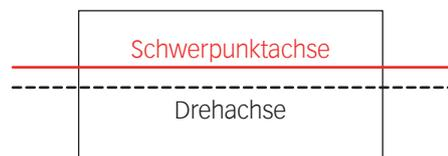
Um eine statische Unwucht zu reduzieren, wird auf einer Ebene Gewicht angebracht, entfernt oder verschoben.
