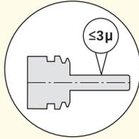
Höhere Bearbeitungsgenauigkeit und bessere Werkstück-Oberflächengüte.
