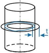
**Rundheit** Die Toleranzzone wird begrenzt durch zwei konzentrische Kreise vom Abstand  $t$ . Die Umfangslinie des tolerierten Zylinders muss in jeder beliebigen Radialschnittebene innerhalb eines Kreisrings der Zonenbreite  $t$  liegen.
