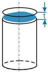
**Ebenheit** Die Toleranzzone wird durch zwei parallele Ebenen vom Abstand  $t$  begrenzt, deren Abmessungen denen der tolerierten Fläche entsprechen. Die reale Werkstückfläche muss zwischen beiden parallelen Ebenen vom Abstand  $t$  liegen.
