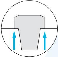
Höhere Steifigkeit durch Kegelanlage (AT1) und Plananlage.
