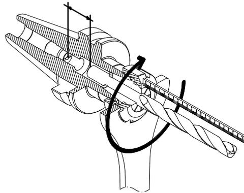
Werkzeuglänge mit Zwischenraum zur Anschlagsschraube einstellen, dann Werkzeug spannen.
