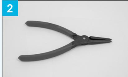
2 Mit Zange Sicherungsring demontieren.
