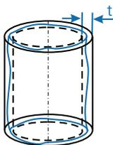
**Zylinderform** Die Toleranzzone für die Zylindermantelfläche begrenzt die Abweichung von der Rundheit, der Geradheit der Mantellinie und von der Parallelität der Mantellinie zur Zylinderachse. Sie wird durch zwei koaxiale Zylinder mit dem radialen Abstand  $t$  gebildet.
