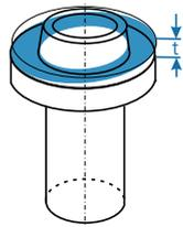
**Rechtwinkligkeit** Die Toleranzzone wird durch zwei parallele Ebenen vom Abstand  $t$  begrenzt, die senkrecht zur Bezugsachse angeordnet sind. Die tolerierte Planfläche muss zwischen diesen beiden Ebenen liegen.
