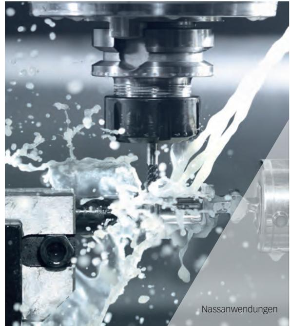
Die Schneide unterliegt thermischen Belastungen. Nassbearbeitung trägt dazu bei, Wärme von der Schneide abzuführen. So wird das Werkzeug optimal vor einem Werkzeugversagen bewahrt.
