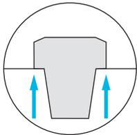
Höhere Steifigkeit durch Kegelanlage (AT1) und Plananlage.
