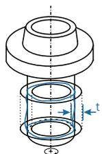
**Gesamtrundlauf** Die Toleranzzone wird begrenzt durch zwei koaxiale Zylinder vom Abstand  $t$ , deren Achsen mit der Bezugsachse übereinstimmen. Bei mehrmaliger Drehung um die Bezugsachse und axialer Verschiebung des Messwertaufnehmers müssen alle Punkte des tolerierten Elements innerhalb der Toleranzzone liegen.
