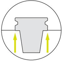
Höhere Steifigkeit durch Kegelanlage (AT1) und Plananlage.
