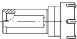
**CYL/ER NC** Die Spannzangenhalter mit zylindrischem Schaft und Fläche sind speziell für CNC-Drehmaschinen geeignet, können aber auch auf konventionellen Drehmaschinen eingesetzt werden.
