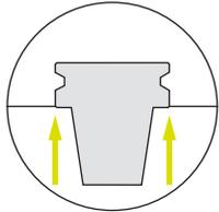
Höhere Steifigkeit durch Kegelanlage (AT1) und Plananlage.
