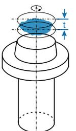
**Gesamtplanlauf** Die Toleranzzone wird begrenzt von zwei parallelen Ebenen vom Abstand  $t$ , die senkrecht zur Bezugs-(Rotations-)achse stehen. Bei mehrmaliger Drehung um die Bezugsachse und radialer Verschiebung des Messwertaufnehmers müssen alle Punkte der Oberfläche der tolerierten Planfläche innerhalb der Toleranzzone liegen.
