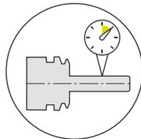
Rundlaufgenauigkeit  $\leq 10 \mu\text{m}$  bei  $3 \times D$ .
