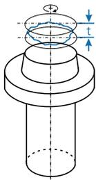
**Planlauf** Die Toleranzzone wird in jedem beliebigen radialen Abstand von zwei Kreisen im Abstand  $t$  begrenzt. Die Kreise liegen in einem Zylinder, dessen Achse mit der Bezugsachse übereinstimmt. Der Durchmesser des Zylinders kann jeden Wert des Durchmessers der Planfläche annehmen.
