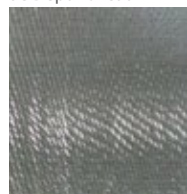
他社 4 枚刃 Competitor 4-flute end mill 等分割・等リード Equal flute spacing Equal helix angle
