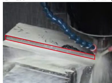
他社 4 枚刃 Competitor 4-flute end mill 等分割・等リード Equal flute spacing Equal helix angle
