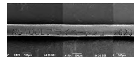
髪の毛への文字彫り「NS TOOL プライベートショー 2020」 Milling on hair
