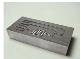
ワークサイズ: 40×20mm (加工深さ0.5mm) Work Size: 40x20mm Machining depth: 0.5mm
