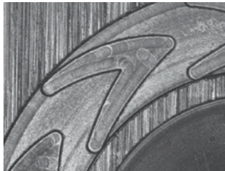
NS-Tool Schneidendesign realisiert eine hohe Stabilität und Lebensdauer Ausgezeichnete Fräsoberfläche am Werkstück • Spezialdesign der Schneidkante • Eckenradius am Werkzeug kleiner als 5\mu\text{m}
