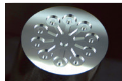
Werkzeug: DCMS-0,3x1,2 Werkstück: \varnothing 6 mm
